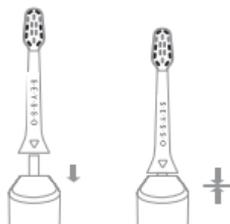
\* Schemat przedstawia poprawny sposób nakładania końcówki na szczoteczkę
